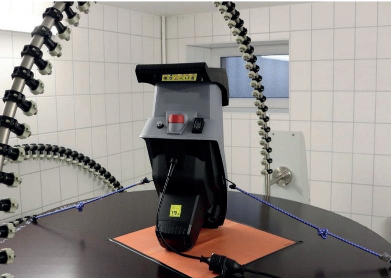
Prüfung der Feuchtigkeitsbeständigkeit - Schutzartprüfung nach IPX4
