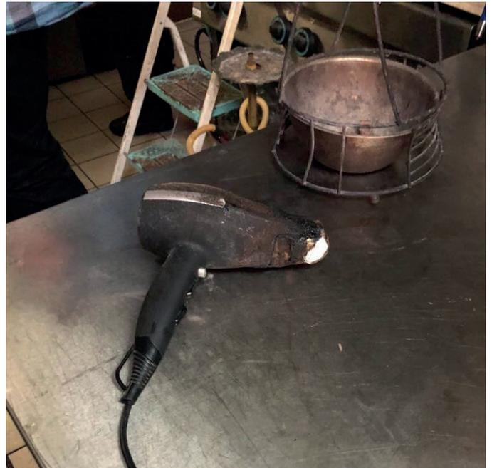
Nicht bestimmungsgemäße Verwendung eines defekten Arbeitsmittels: Haartrockner mit geschmolzenem Gehäuse zur Kohlevorbereitung
