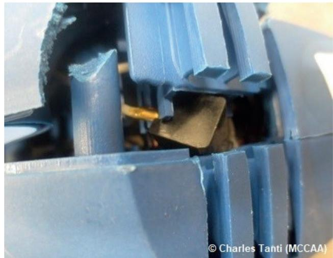
Gebrochenes Gehäuse - Zugang zu spannungsführenden Teilen
