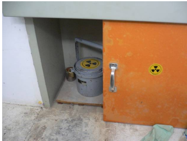
Abb. 17: Sichere Lagerung eines radioaktiven Strahlers im Tresor
